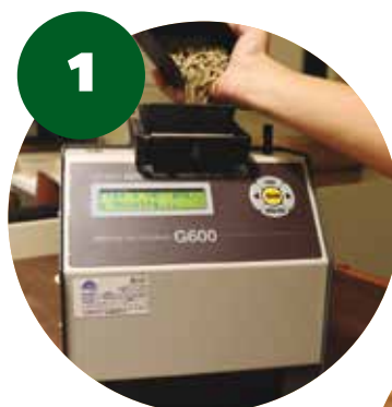
Colocando grãos dentro do determinador de umidade
