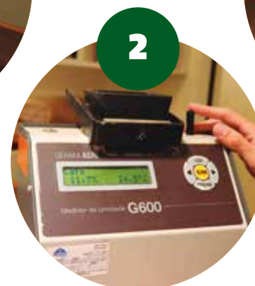
Temperatura e umidade após colocar grãos dentro do medidor
